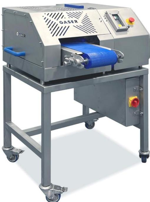
Машина для нарезки грудок всех типов с производительностью до 400 кг/час.
