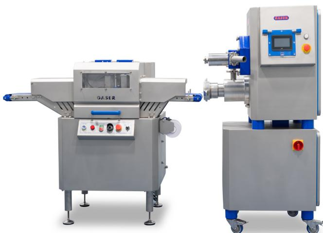
Línea de producción para porciones de peso fijo para todo tipo de producto: picado (free-flow), pastilla, cilindros (cevapcici) y otras formas. Línea formada por embutidora, cabezal picador y porcionador automático.
