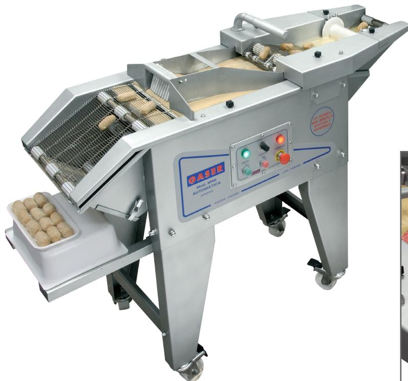
Modelo industrial básico, serviría para producciones medias y se puede empanar todo tipo de productos. Dispone de accesorios tales como regulación de velocidad de las cintas transportadoras y turbina de soplado del encolante sobrante.
